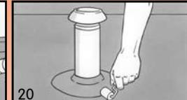
Découper le segment de la buse dans la **Toiture en caoutchouc**, et passer celle-ci par-dessus la buse (17+18). La finition s'effectue au moyen d'une **Manchette** universelle.
