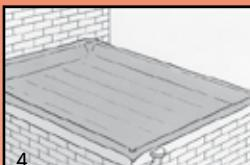
Le support doit être exempt de saleté, de poussière, d'humidité, de graisse, d'élément tranchant et de tout autre matériau qui pourrait causer des dégâts à la **Toiture en caoutchouc** ou empêcher une adhérence optimale de la colle **Toiture en caoutchouc** epdm.
