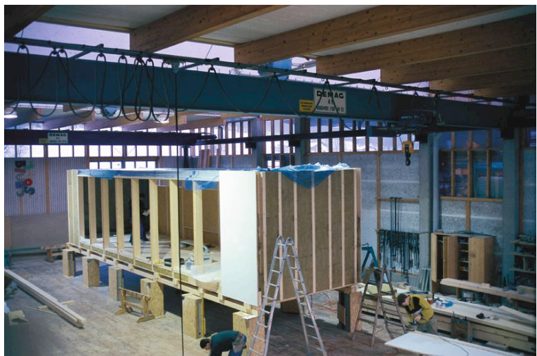
Fabrication d'une unité modulaire SU-SI chez le constructeur Michael Kaufmann photo : J. Kaufmann Architektur
