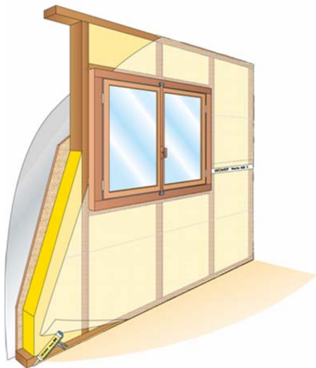
Vue d'ensemble : liaison en parties haute et basse, et avec fenêtre
