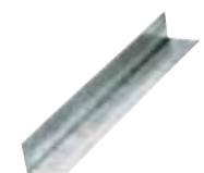
**Cornière plafond** Pour la liaison entre la périphérie des pièces et les fourrures de plafond, ou le maintien des fourrures au sol et au plafond dans le cas d'utilisation en doublage de mur. Longueur : 3 m. Section : 24 x 34 mm.
