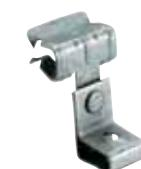
**3. Attache M6** Pour assurer la fixation d'une tige filetée Ø 6 mm sur profilé métallique de charpente métallique. À utiliser en association avec la suspente pivot et une tige filetée Ø 6 mm. Vendue à l'unité ou en boîte de 100.
