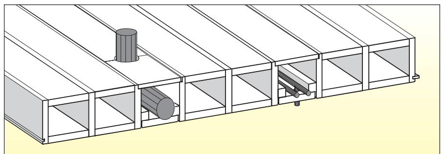
La couche isolante entre caisson et revêtement de sol est l'endroit idéal pour la pose de tuyaux de petit diamètre.
