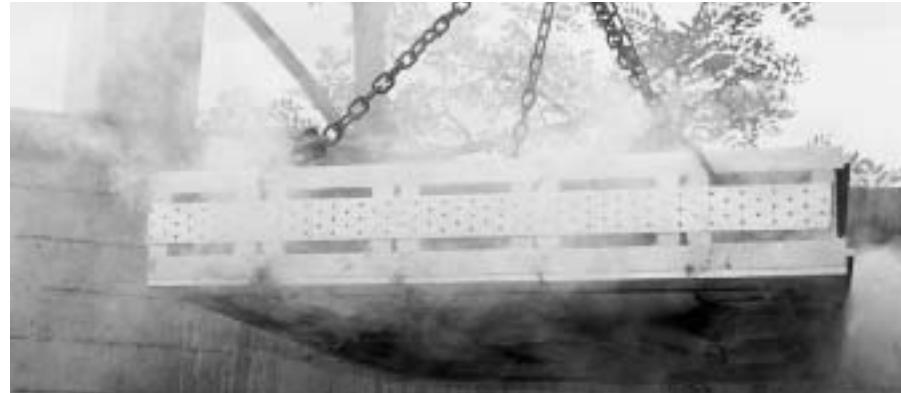
Le calcul de la résistance au feu s'effectue sur la base de la section résiduelle et des contraintes caractéristiques modifiées ci-contre.
