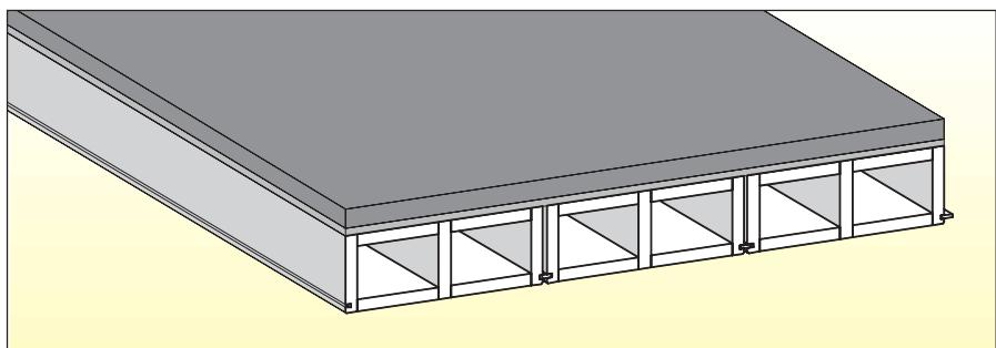
Le caisson multiple LIGNATUR se prête à la construction de planchers à structure discontinue et permet des solutions particulièrement économiques.
