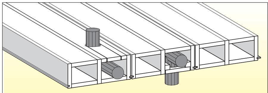
La distribution transversale est réalisée pour plus de simplicité dans la zone de l'appui.
