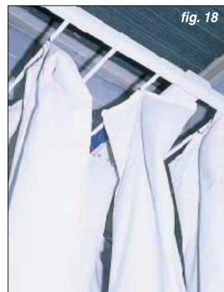
Le groupe est implanté dans un local fermé : le moteur comporte un excentrique qui fait vibrer le support métallique des sacs.
