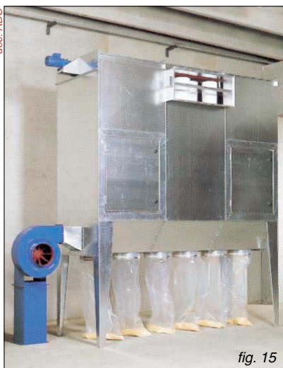
Groupe filtrant avec récupération des copeaux dans des sacs.
