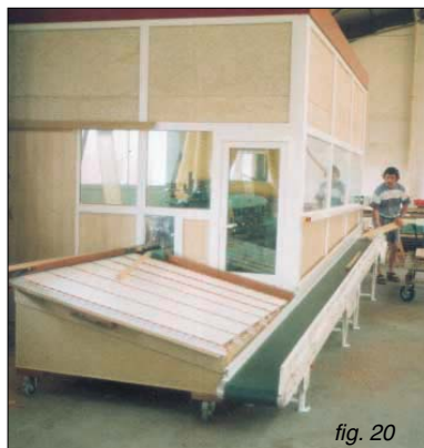
La moulurière est entièrement encoffrée par une cabine et comporte en sortie un tapis qui ramène les pièces à l'opérateur.
