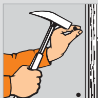
Figure 9 : Clouage sur ossature bois
