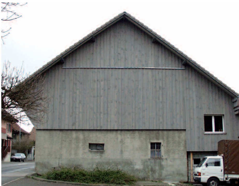
Le prégrisaillement permet d'obtenir un aspect "vieux bois" uniforme.
