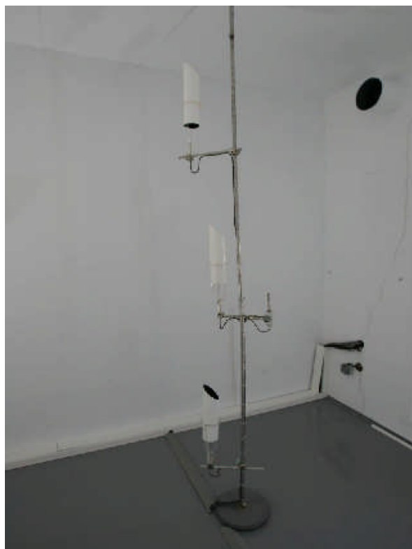
Figure 2.5 – Mat équipé de capteurs de température
