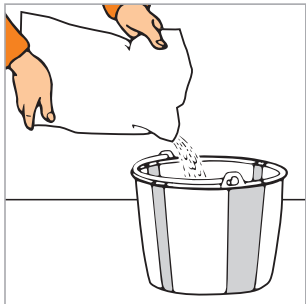
Figure 23 : Disperser l'enduit pour joints dans l'eau
